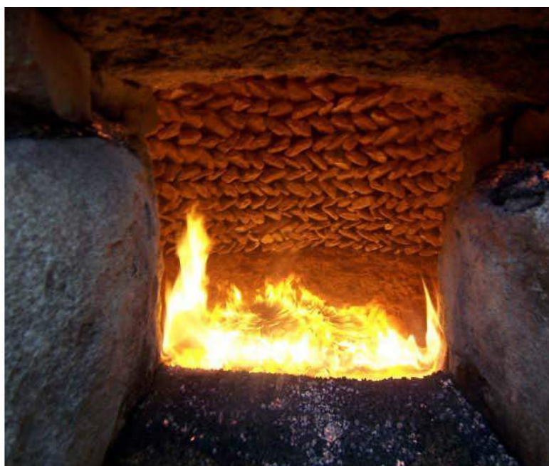
Foto 12.- Fuego en la cámara de cocción o “calderuela”.
